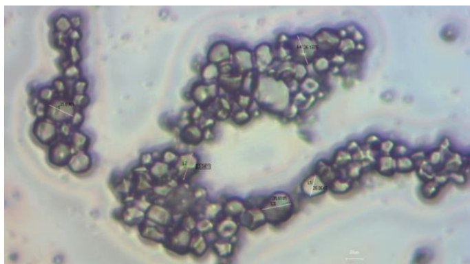
(b) 4000# \text{Al}_2\text{O}_3 磨粒动态“粒子簇”(200 \times )
