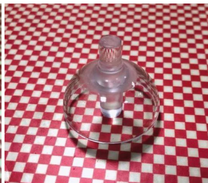
内外表面抛光后 R_a 6.9nm
