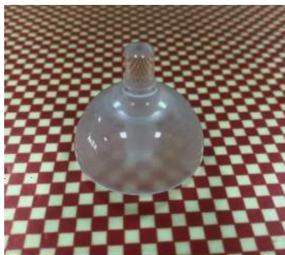
外表面抛光 R_a 7.9nm
